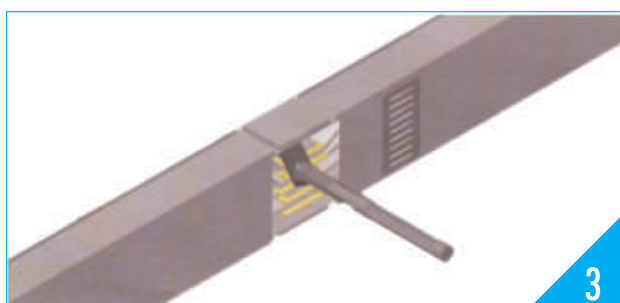
3) Ajuste el tornillo con la herramienta de acuerdo al valor específico.
