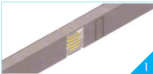
1) Ubique la barra acoplando los puntos de unión
