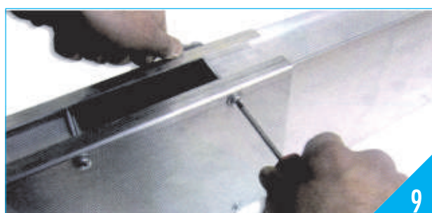
9) Arme las coberturas frontales y traseras, ponga los tornillos.
