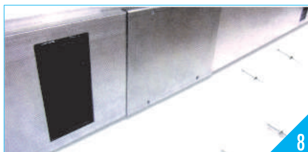
8) Arme las coberturas frontales y traseras.
